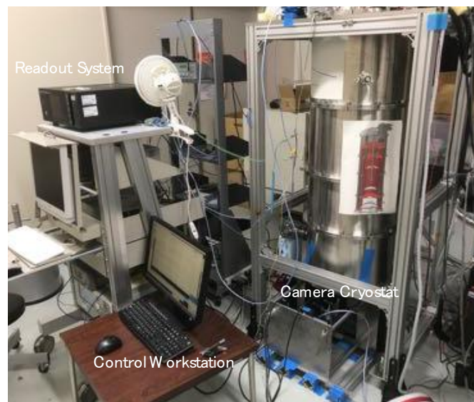
図 1. 100-GHz 帯 MKID カメラと周辺システム
