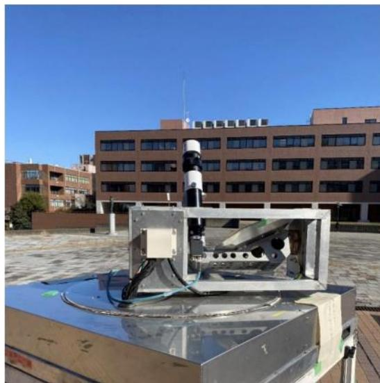
図 5. 筑波大学構内での光学ポインティング試験観測の様子（学士論文 1）
