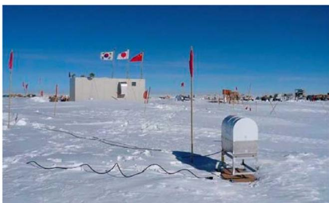
ドームふじ基地と大気透過率測定用の220GHzラジオメータ（手前）。
