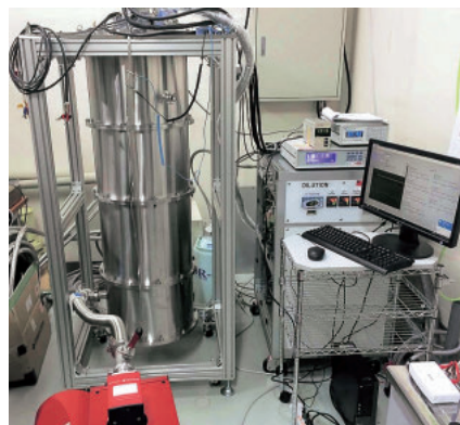
野辺山45m電波望遠鏡に搭載した超伝導電波カメラ
