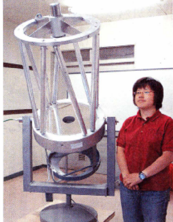
低温環境を考慮して開発中の東北大の40センチ赤外線望遠鏡。市川隆教授提供
